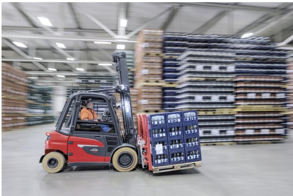
Bei der Ensinger Mineral-Heilquellen GmbH be- und entladen leistungsfähige Elektrostapler bis zu 60 Lkw pro Tag (Bild: Linde Material Handling).
