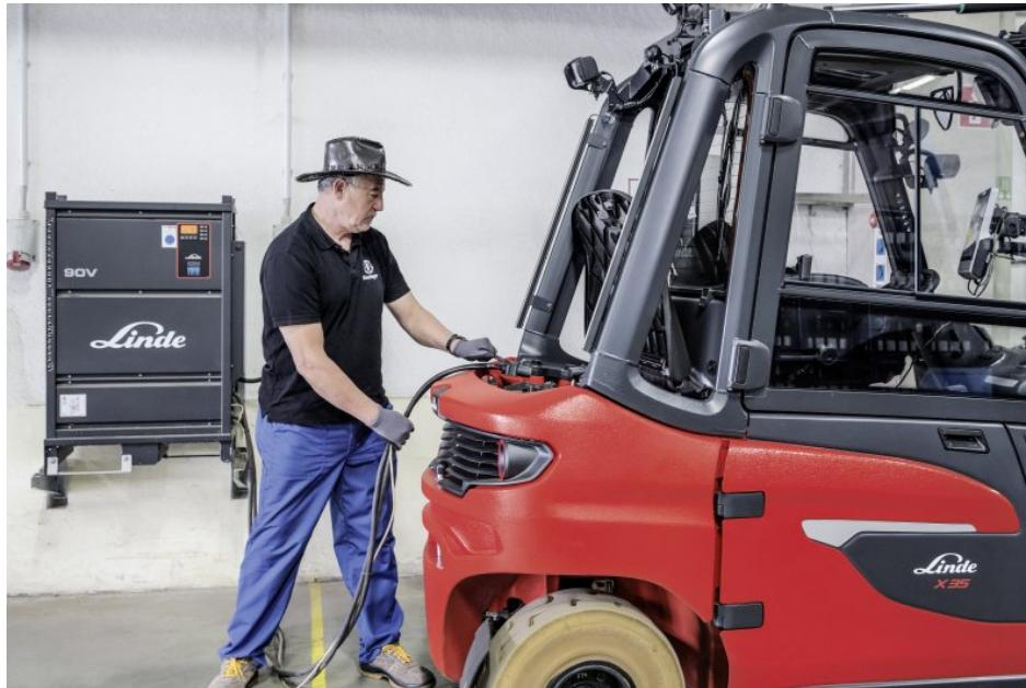
Mit jeweils einem kurzen Ladestopp je Schichtpause kommt der Elektrostapler über zwei Schichten (Bild: Linde Material Handling).
