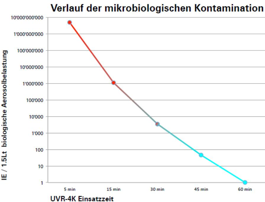
Innerhalb von nur 60 Minuten wurden keine Phi6 Bakteriophagen mehr nachgewiesen (Diagramm: sterilAir).
