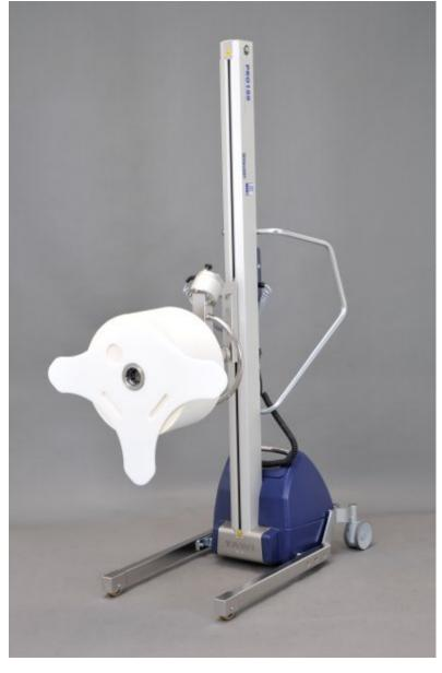
Mit dem leistungsstarken, wendigen, kompakten und leichten Hebegerät können teleskopierende Rollen bis zu einem Gewicht von 200 Kilogramm (Bild: Transort) ...
