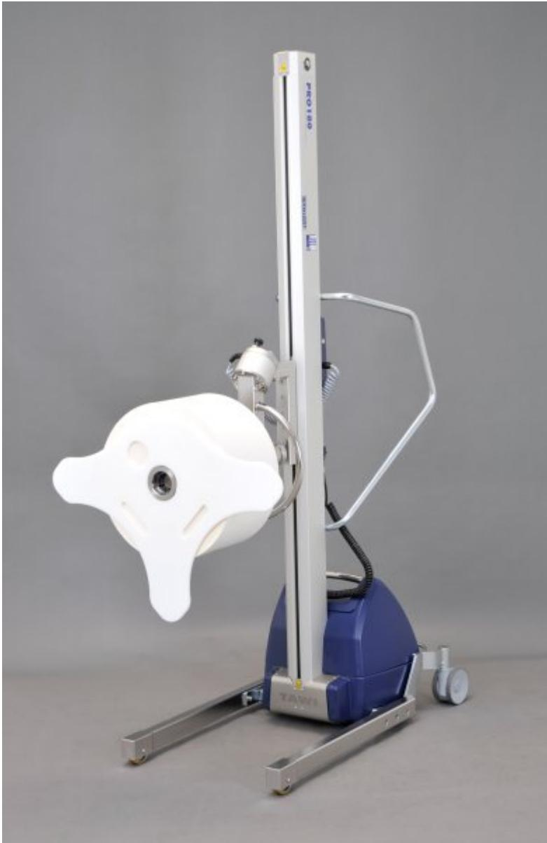
Mit dem leistungsstarken, wendigen, kompakten und leichten Hebegerät können teleskopierende Rollen bis zu einem Gewicht von 200 Kilogramm (Bild: Transort) ...
