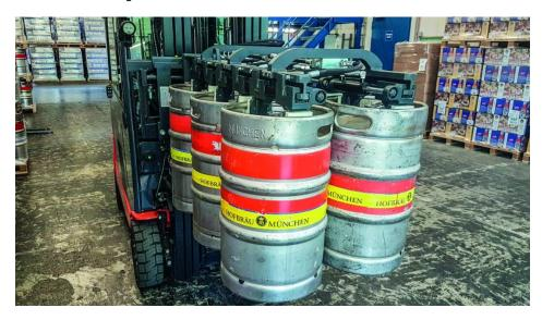
Eine Sonderlösung greift das Ladegut von oben und ermöglicht so die Containerbeladung mit halbem Personal in weniger als der Hälfte der Zeit (Bild: Kaup).
