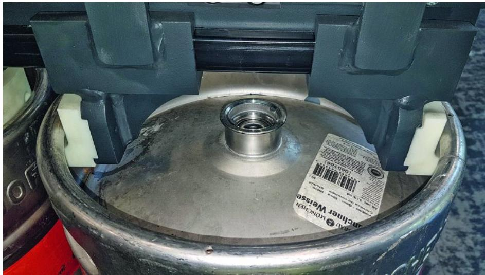
Hauptbestandteil sind sechs Spreizvorrichtungen mit jeweils zwei Spreizern. Diese Vorrichtungen sind an einem Ausleger angeordnet, der von oben auf die Fässer abgesenkt wird (Bild: Kaup).
