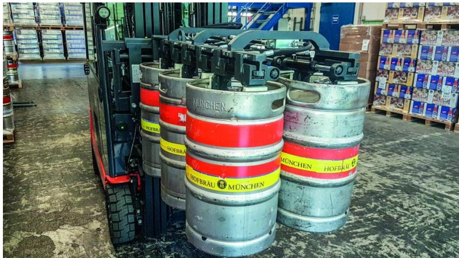
Eine Sonderlösung greift das Ladegut von oben und ermöglicht so die Containerbeladung mit halbem Personal in weniger als der Hälfte der Zeit (Bild: Kaup).
