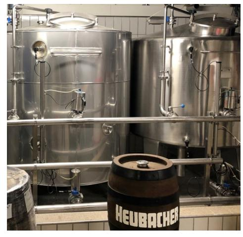
Das Desinfektionsmittel kann im CIP-Tank auch gestapelt werden, wodurch viel Wasser eingespart werden kann (Bild: Innowatech).
