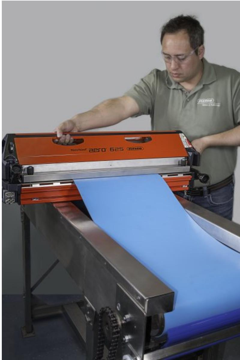
Die Handhabung der überarbeiteten Presse ist besonders einfach, der eigentliche Verbindungsvorgang läuft automatisch ab (Bild: Flexco).
