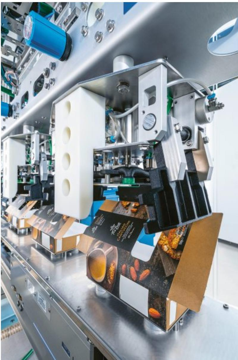
Das kostengünstige, leicht zu verarbeitende Design der Schachteln für das Bag-in-Box-Konzept trägt zur Effizienzsteigerung des Verpackungsprozesses bei (Bild: Schubert).
