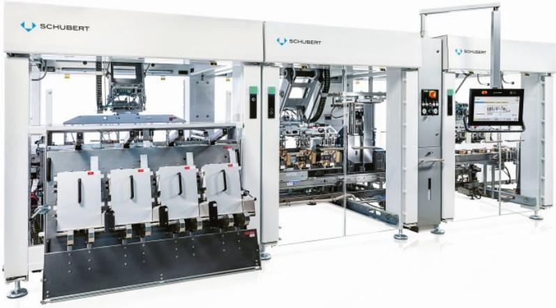
In der neuen Verpackungsmaschine verbindet das »Transmodul« alle Verpackungsschritte nahtlos und effizient miteinander (Bild: Schubert).
