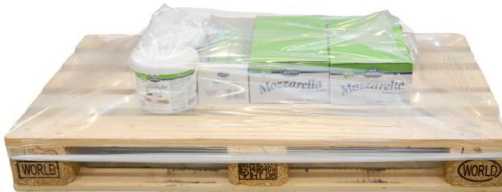
Auch einlagig und unregelmäßig gepackte Paletten können automatisiert mit einer Stretchfolie verpackt werden (Bild: Signode).
