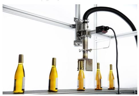
Die neuen Lufterhitzer eignen sich zum Beispiel durch Ausstattung mit einer Siebreflektordüse besonders für Schrumpfanwendungen in der Verpackungstechnik (Bild: Leister).
