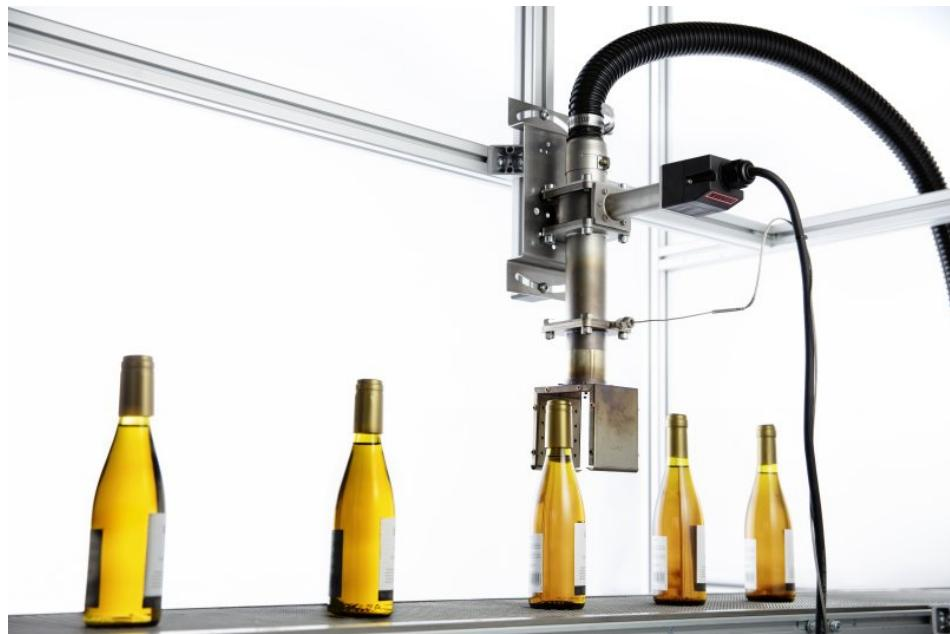
Die neuen Luftheritzer eignen sich zum Beispiel durch Ausstattung mit einer Siebreflektordüse besonders für Schrumpfanwendungen in der Verpackungstechnik (Bild: Leister).
