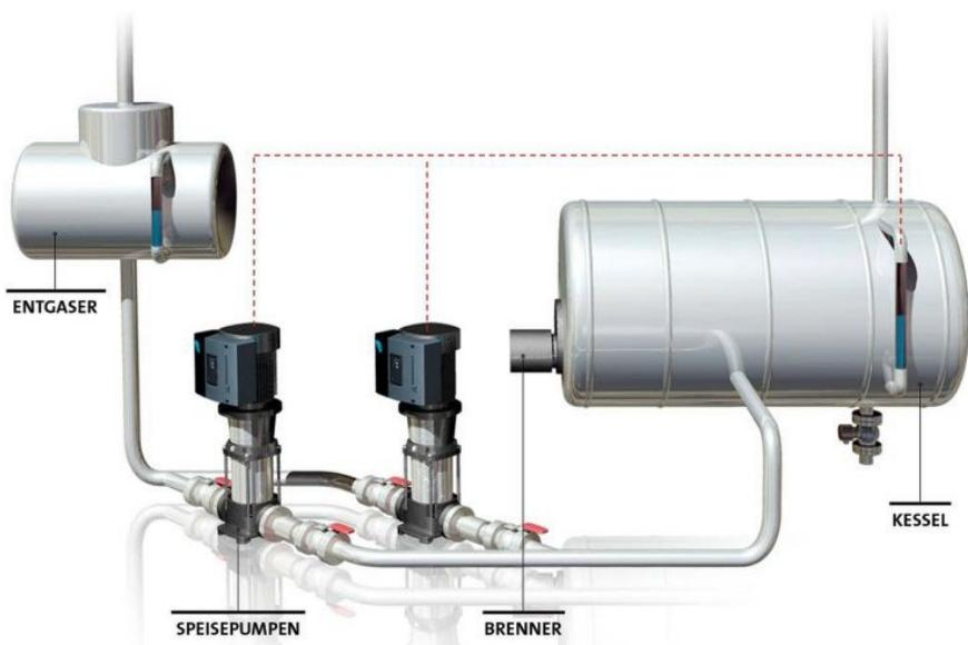
Grundfos hat eine Kesselspeisungsanlage entwickelt, die kein Zulaufventil benötigt, da eine drehzahlregelbare Pumpe über einen Füllstandsensor selbst für die Regelung sorgt (Bild: Grundfos).
