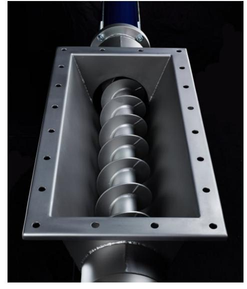
Die Trichterpumpe ist mit einer Förderschnecke ausgestattet, die Gebackenes und Teige miteinander so vermischt, dass keine Brückenbildung entsteht (Bild: Seepex).
