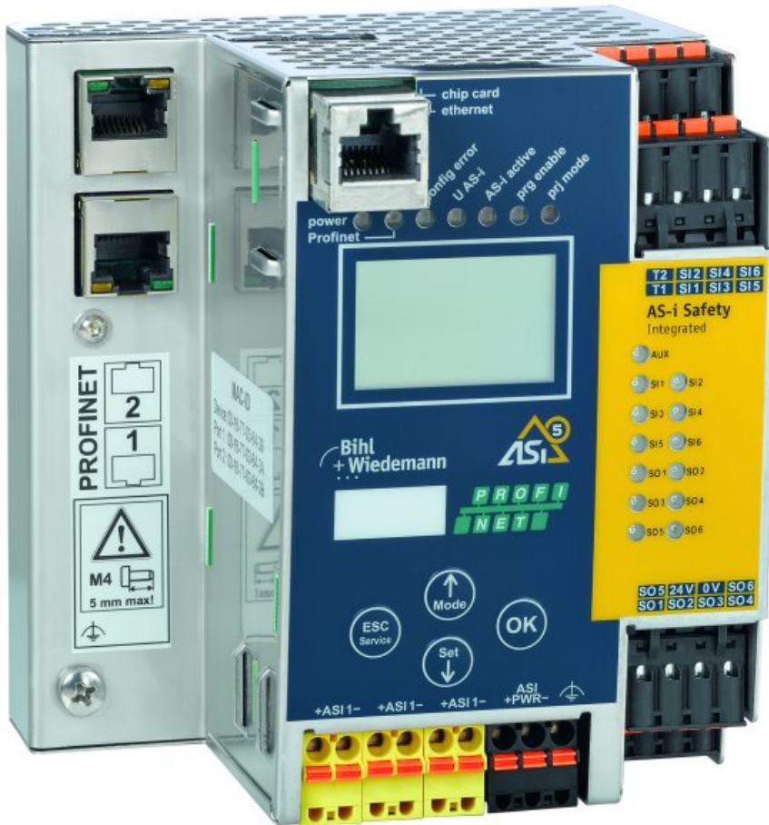
ASi-5/ASi-3-ProfiSAFE-über-Profinet-Gateway mit integriertem Sicherheitsmonitor (Bild: Bihl+Wiedemann).
