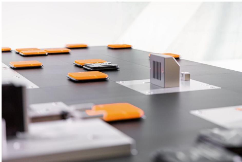
Durch die Auflösung des linearen Produkttransports wird ein mehrdimensionaler Produktionsraum geschaffen (Bild: B&R).
