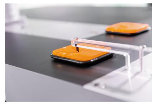
Die Shuttles des Transportsystems »Acopos 6D« können mit einem Werkstück CNC-Pfade abfahren, während das Bearbeitungswerkzeug starr angebracht ist (Bild: B&R).
