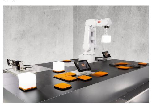
Flexible Transportsysteme können jedes Produkt individuell bewegen und auch als eigenständige Achse bei Bearbeitungsstationen eingesetzt werden (Bild: B&R).
