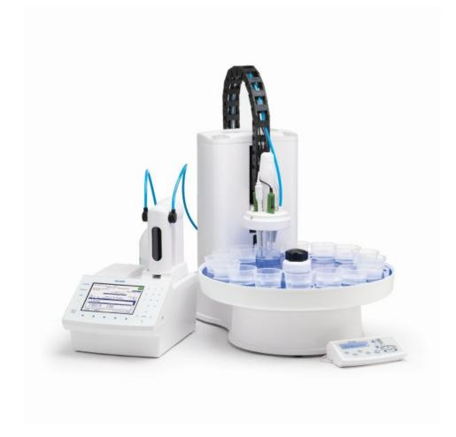
Das Titrationssystem ist mit einem automatischen Probenwechsler kombinierbar (Bild: Hanna Instruments).
