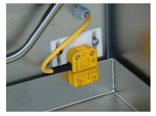
Beim Öffnen der Abdeckung sorgt der berührungslose, codierte Sicherheitsschalter dafür, dass das Messer in der Portioniermaschine sofort sicher abgeschaltet wird (Bild: Pilz).
