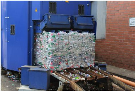
Die PET-Flaschen werden anschließend in der vollautomatischen Ballenpresse in direktvermarktungsfähige Ballen verdichtet (Bild: tbd).
