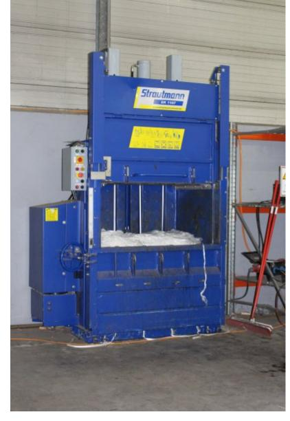
Dank Verdichtung der Folien durch die Ballenpressen können jetzt acht bis zehn Tonnen Folie in einer Mulde gesammelt werden (Bild: Strautmann).
