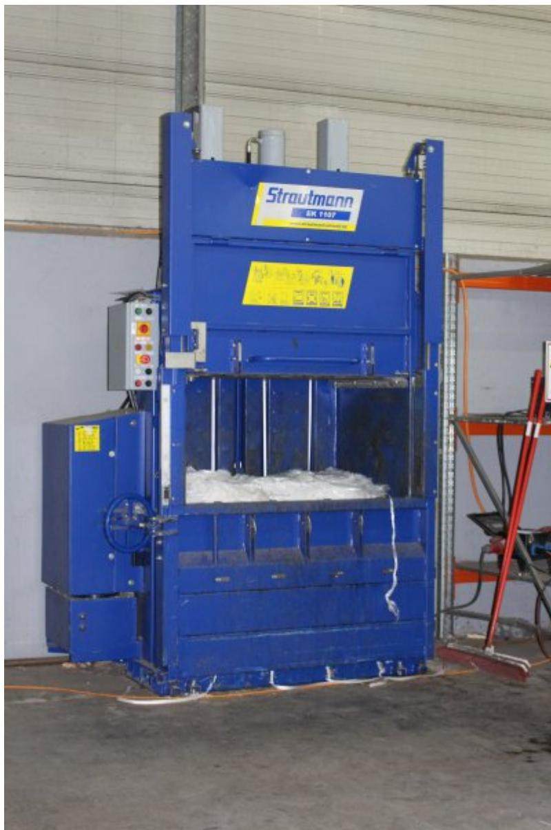
Dank Verdichtung der Folien durch die Ballenpressen können jetzt acht bis zehn Tonnen Folie in einer Mulde gesammelt werden (Bild: Strautmann).
