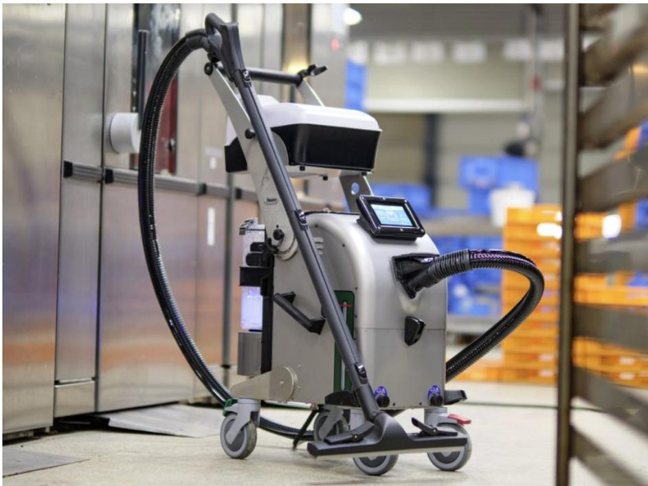
Das Touchdisplay erleichtert die Bedienung des Dampfsaugers (Bild: Beam).
