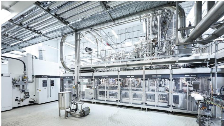
Der neue Streckblas-Füllblock ist eine platzsparende Anlagenlösung für die Abfüllung sensitiver Getränke in PET-Flaschen (Bild: KHS).
