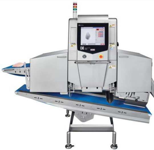
Das Röntgenprüfsystem bewältigt auch besonders schwierige Aufgaben der Fremdkörperkontrolle (Bild: Ishida).
