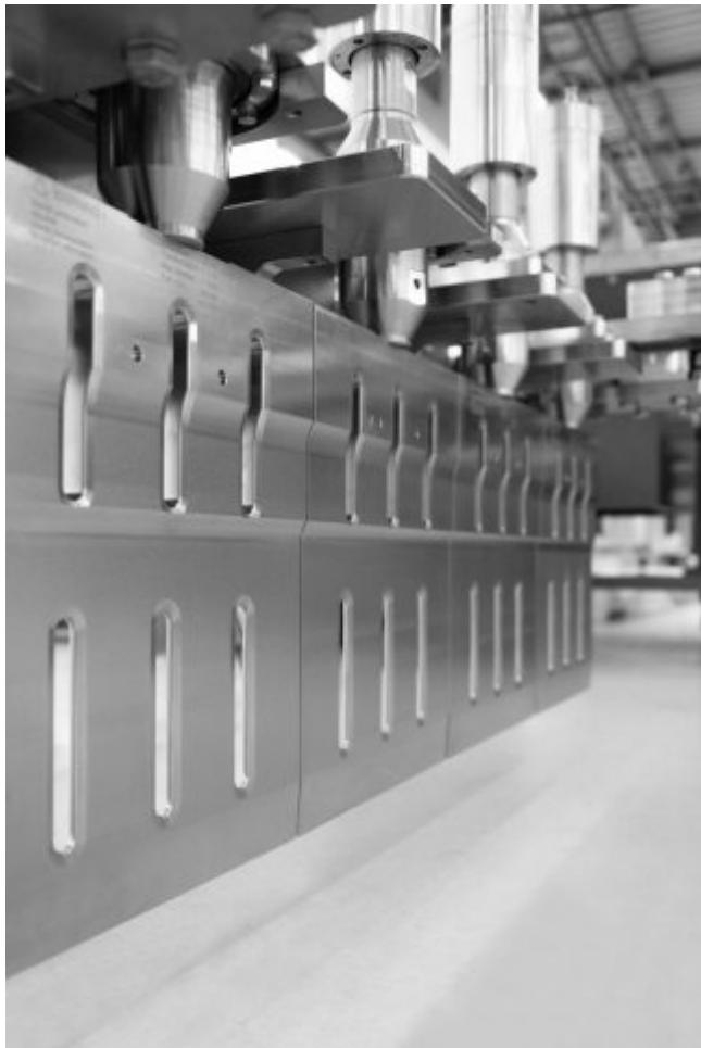
Die Ultraschallschneidsysteme sorgen für einen sauberen Schnitt bei Konditoreierzeugnissen wie Bienenstich (Bild: MS Ultraschall).
