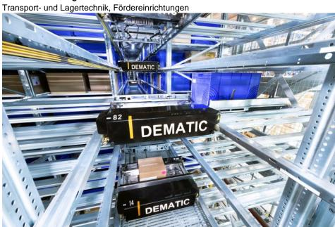
Die dreigassige Lagerautomationslösung bietet 75.000 Behälterstellplätze, auf die 85 Shuttles automatisch zugreifen (Bild: Dematic).
