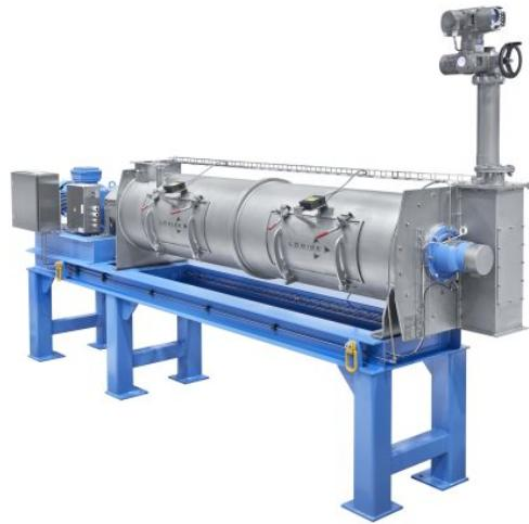
Mit anwendungsspezifisch ausgeführten Pflugscharmischern lassen sich jodierte und fluorierte Tafelsalze mischen (Bild: Lödige).
