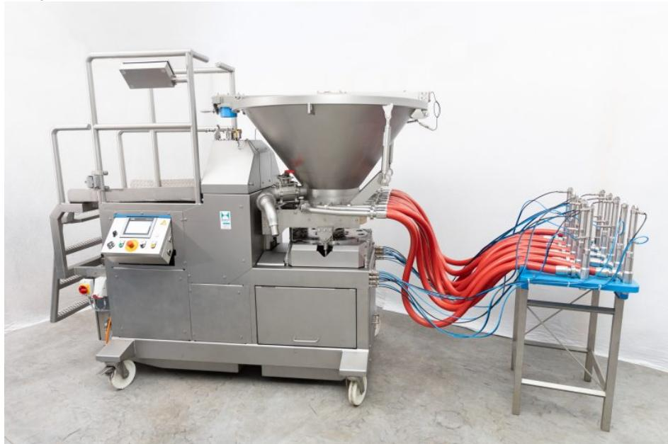
Der mobile Füller dosiert flüssige bis pastöse Produkte an bis zu zwölf Füllstellen mithilfe einer einzigen Steuersetzung (Bild: Holmatec).
