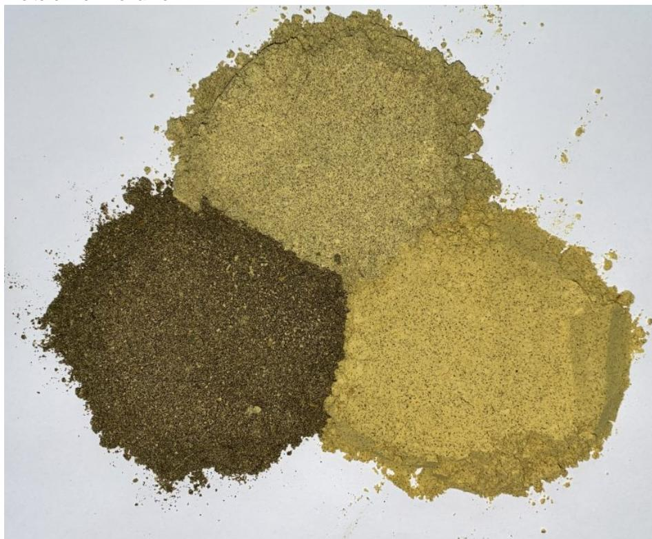
Beispiel für Rapsprodukte, die mithilfe des triboelektrischen Bandtrennverfahrens gewonnen werden (Bild: Luise Wockenfuss).
