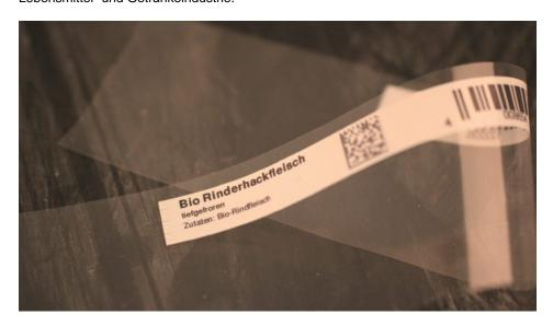
Ein hochauflösender Tintenstrahldrucker schreibt Etiketteninhalte direkt auf die Folie (Bild: REA Elektronik).
