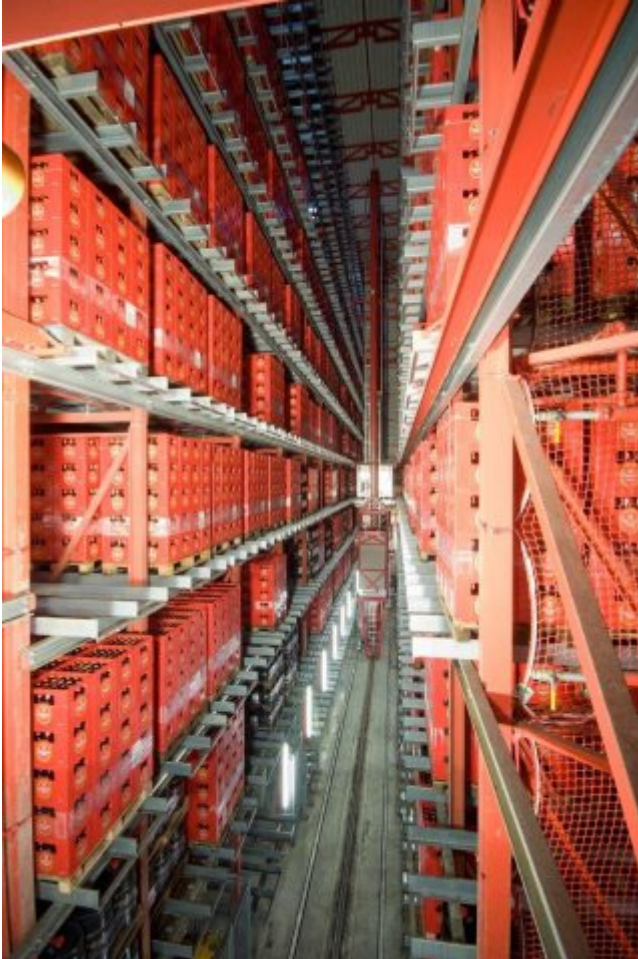
Automatisches Hochregallager für die Privatbrauerei Heinrich Reissdorf GmbH & Co.KG mit 3445 Regalstellplätzen für Europaletten (Bild: Westfalia Logistics).
