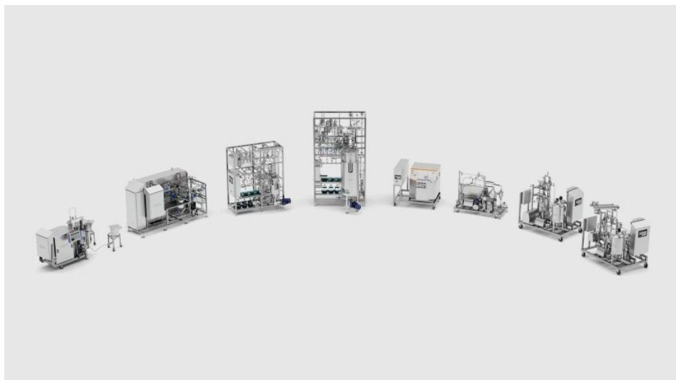
Das modulare Testzentrum ist eine voll ausgestattete Prozesslinie im Pilotmaßstab für das Erzeugen von zellulären und azellulären Produkten im Bereich New Food (Bild: [Gea](#)).
