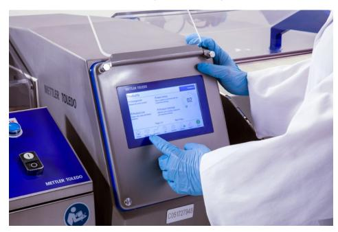
Beispiel für ein aktuelles Metallsuchsystem mit Vollfarb-Touchscreen für eine einfache Bedienung (Bild: Mettler Toledo).
