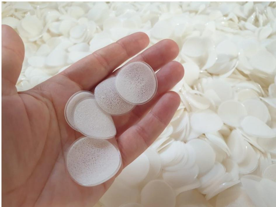
Der »BioChip« ist ein Trägermedium für die Ansiedlung von Mikroorganismen. Die Bakterien setzen sich in das feinporige System und verstoffwechseln die biologisch abbaubaren Substanzen im Abwasser (Bild: Mutag).
