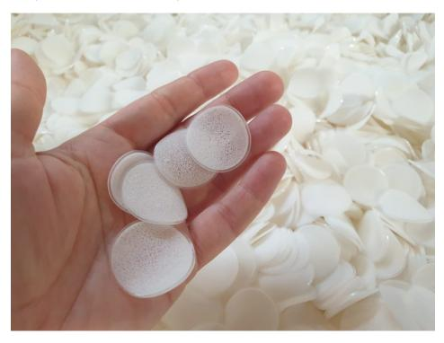
Der »BioChip« ist ein Trägermedium für die Ansiedlung von Mikroorganismen. Die Bakterien setzen sich in das feinporige System und verstoffwechseln die biologisch abbaubaren Substanzen im Abwasser (Bild: Mutag).
