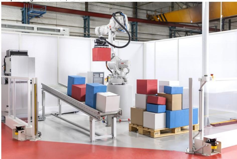
Mit dem neuen Depalettierer lassen sich dank Bildverarbeitung manuelle Aufgaben effizient automatisieren (Bild: ABB).
