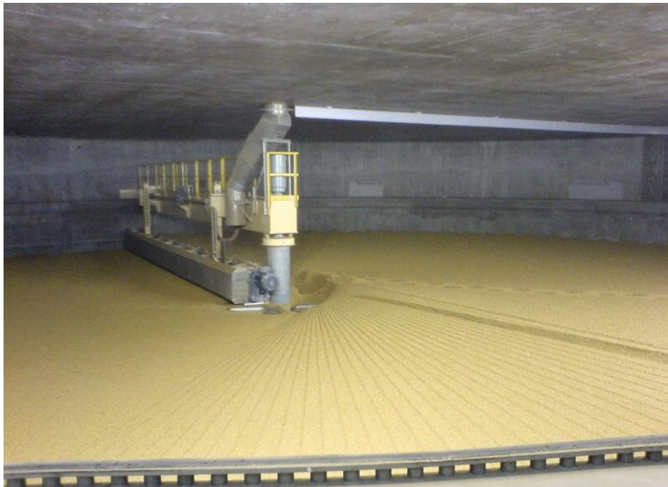
Die Malztrocknung in Darren bietet ein Fassungsvermögen von 400 t (Bild: Zeppelin Systems).
