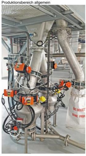
Die Verwendung von Doppelsendern reduziert den Höhenbedarf (Bild: Gericke).
