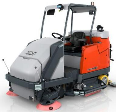
Kombinations-Kehrsaug- und Scheuersaugmaschine mit Hochentleerung und Fahrerschutzdach (Bild: Hako).
