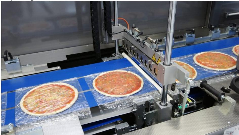
Die Verpackungsmaschine sorgt ohne Folienreststreifen für Frischeverpackungen bei Pizzas (Bild: Kalfass).
