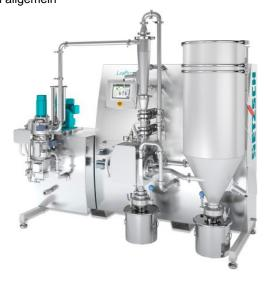
Das überarbeitete Mahl-/Sichtsystem in einer Konfiguration mit Sichtermühle und Hochleistungsfeinstsichter (Bild: Netzsch).
