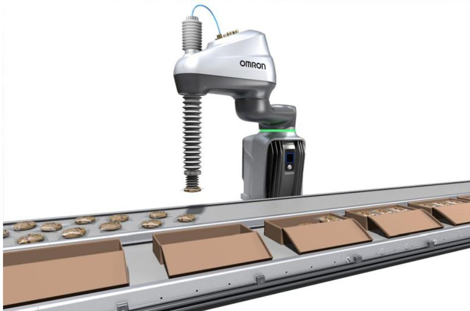
Die lebensmittelzugelassenen Scara-Roboter eignen sich auch zur Handhabung nicht verpackter Lebensmittel (Bild: Omron).
