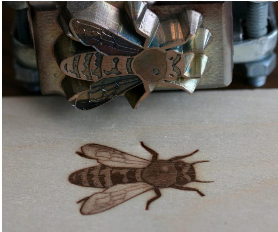
Beispiel für einen Brennstempel zur Kennzeichnung von Holzkisten (Bild: Gravierbetrieb Wagner).
