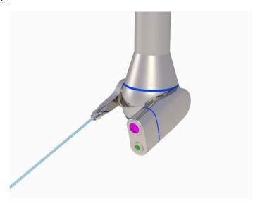
Der integrierte Sensor ermöglicht ein permanentes Inline-Monitoring für eine adaptive, vollumfänglich dokumentierbare Reinigung (Bild: Hohe Tanne GmbH).
