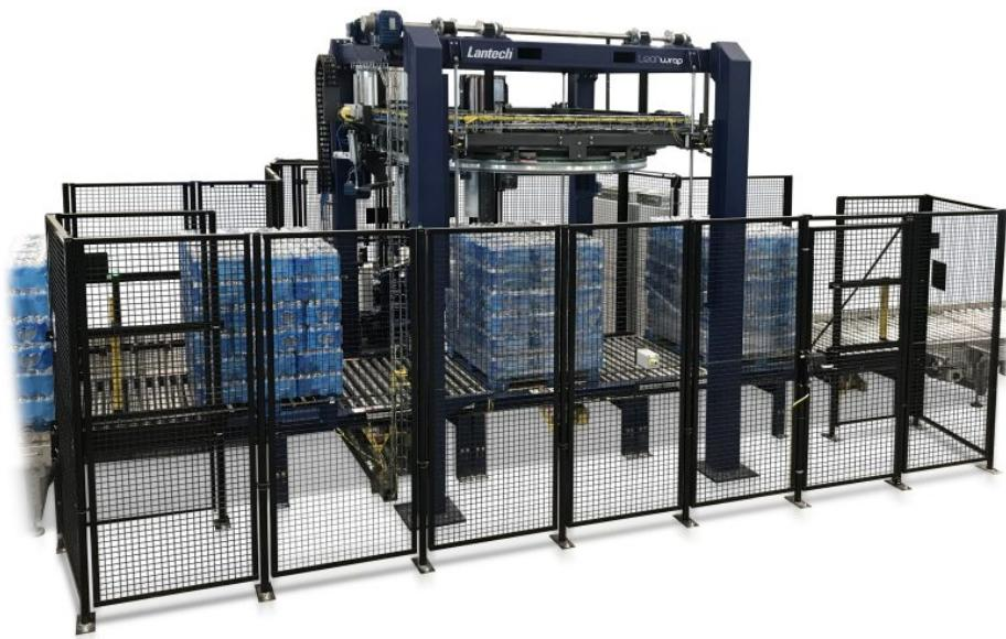
Der vollautomatische Ring-Stretchwickler umwickelt bis zu 180 Ladungen pro Stunde (Bild: Lantech).
