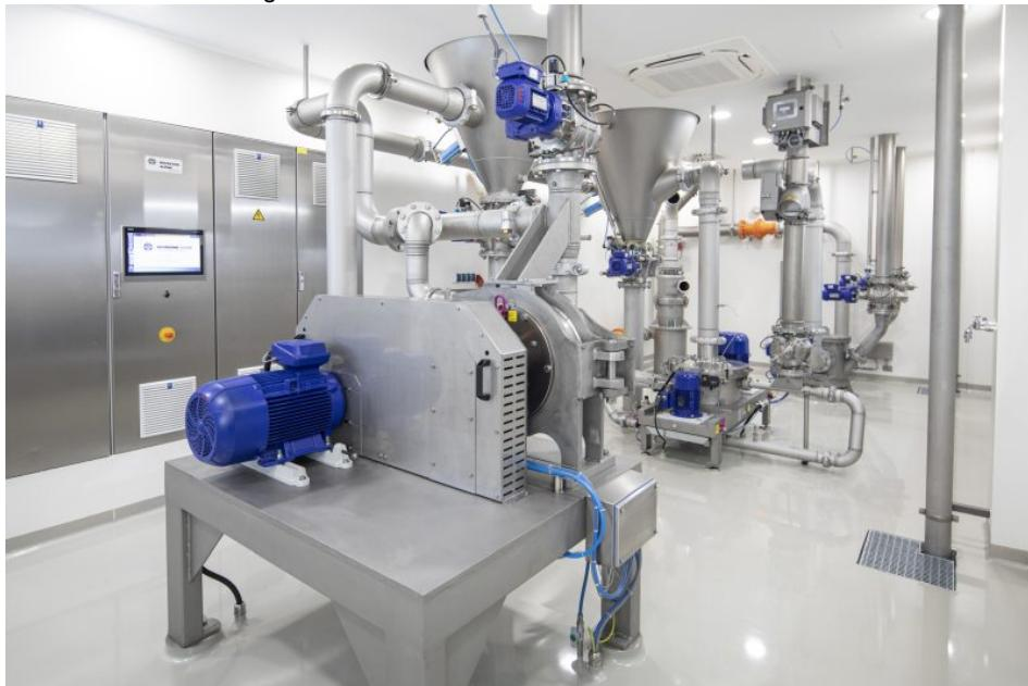
Beispielhafte Feinprallmühle, aufgebaut im »Application Center Food« in Augsburg (Bild: Hosokawa Alpine).
