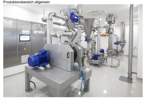
Beispielhafte Feinprallmühle, aufgebaut im »Application Center Food« in Augsburg (Bild: Hosokawa Alpine).
