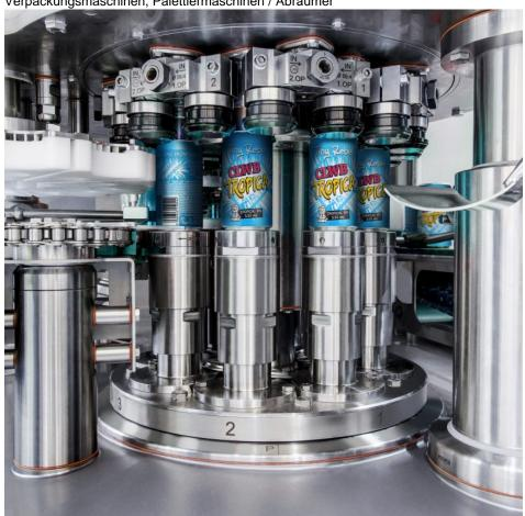
Der neue Dosenfüller mit Dosenverschließern von Ferrum konnte die Effizienz im Abfüllprozess um bis zu 40 % verbessern (Bild: KHS).
