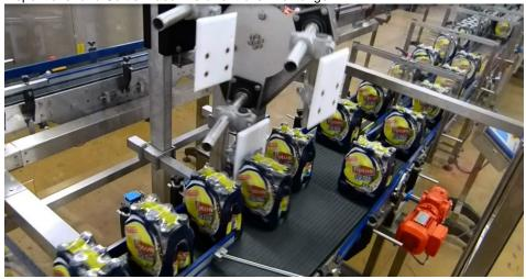
Die Sortieranlagen verteilen Produkte vom kleinen Zweierpack bis zum 24er-Tray auf zwei, drei, vier oder fünf Bahnen (Bild: Sortec).
