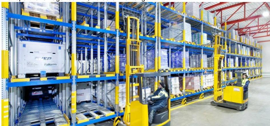
Das Deutsche Milchkontor nutzt z. B. für die Tourenbereitstellung in der Verladezone am Warenausgang Palettendurchlaufregale (Bild: Bito).
