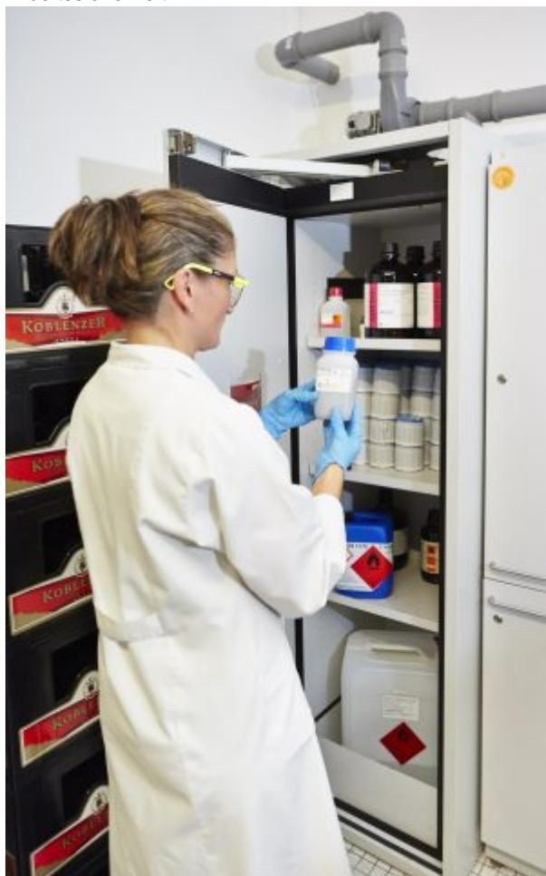
Der Gefahrstoffschrank ermöglicht die sichere Lagerung von Gefahrstoffen in der Nähe des Arbeitsplatzes (Bild: asecos).
