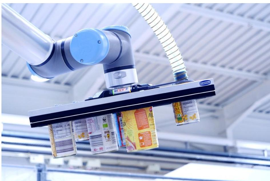
Dank des geringen Eigengewichts kann der Leichtbau-Lagengreifer auch an Leichtbaurobotern eingesetzt werden (Bild: J. Schmalz GmbH).
