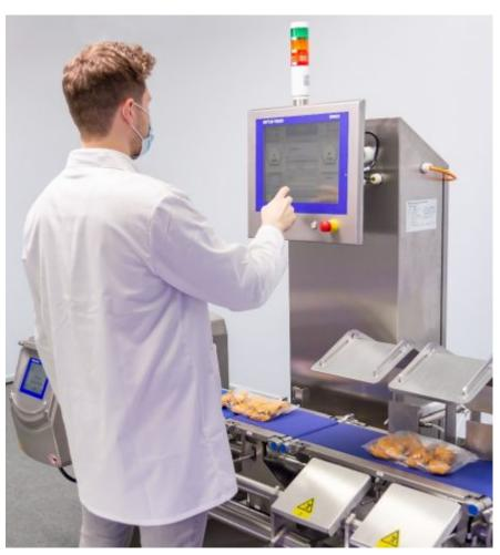
Kombisysteme vereinen verschiedene Produktinspektionstechnologien. Im Bild: Kontrollwägen und Metallfremdkörpererkennung (Bild: Mettler Toledo).
