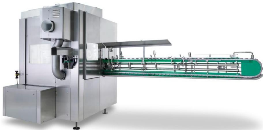
Die Verschließer für Getränkedosen aus Stahl, Aluminium oder Kunststoff verschließen bis zu 150.000 Dosen pro Stunde (Bild: Ferrum).
