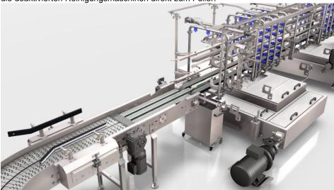
Im Außenwascher erfolgt der Formatwechsel durch die automatische Höhen- und Breitenverstellung der Keg-Führung (Bild: KHS).
