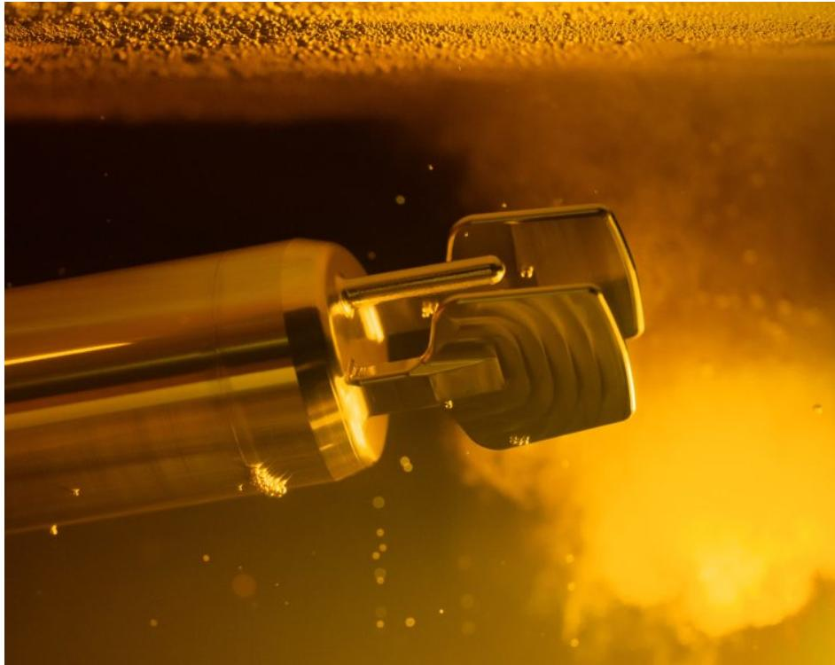
Die Sensorik des »Fermentation Monitor QWX43« mit Schwinggabelzinken und Temperaturfühler taucht direkt ins Bier ein und misst kontinuierlich Dichte, Ultraschalllaufzeit und Prozesstemperatur (Bild: Endress+Hauser).
