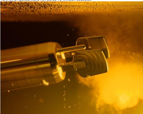
Die Sensorik des »Fermentation Monitor QWX43« mit Schwinggabelzinken und Temperaturfühler taucht direkt ins Bier ein und misst kontinuierlich Dichte, Ultraschalllaufzeit und Prozesstemperatur (Bild: Endress+Hauser).
