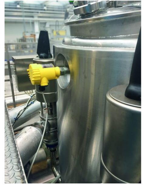
Die genaue Druck- und Füllstandmessung ist wesentlich für die Qualität der Konfitüren. Die Sensoren begleiten die Herstellung und tragen so zur hohen Qualität bei. (Bild: Vega).
