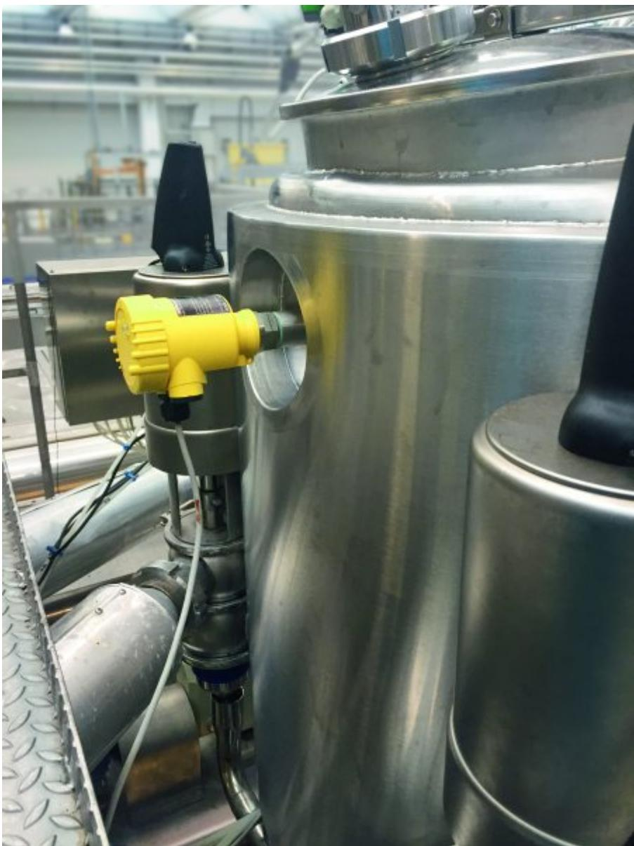
Die genaue Druck- und Füllstandmessung ist wesentlich für die Qualität der Konfitüren. Die Sensoren begleiten die Herstellung und tragen so zur hohen Qualität bei. (Bild: Vega).
